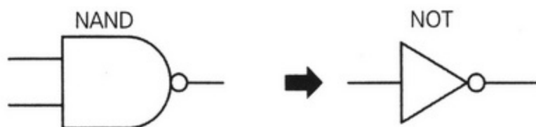
图5.13 通过NAND制作NOT电路
